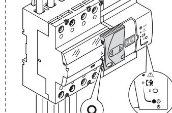
Röd LED semi-tillfälligt fel: Enheten har kontrollerat anläggningen samt identifierat fel och går då ned i "väntstatus" där anläggningen kontrolleras varannan minut, om felet försvinner återstartar jordfelsbrytaren automatiskt.
