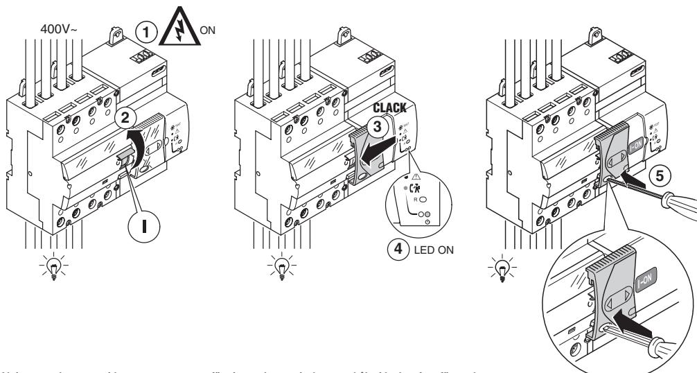
Aktivera testknappen vid uppstart genom att föra in en skruvmejsel genom hålet i luckan framför testknappen.
